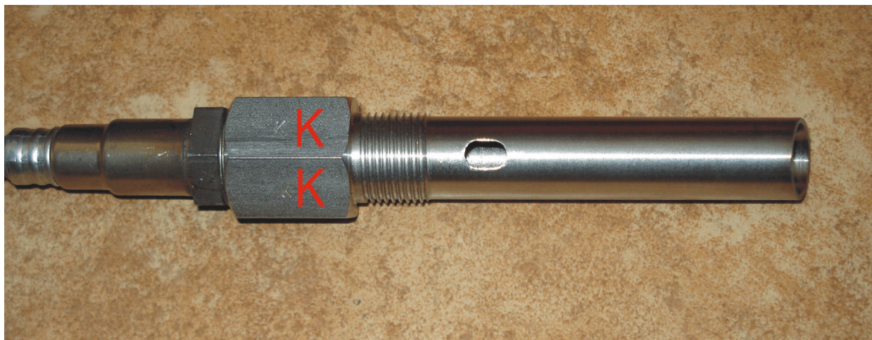
Rys.3. Sonda lambda zamontowana w osłonie
